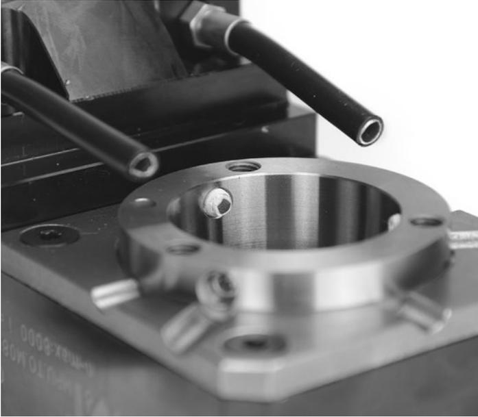
Der Ein- und Ausbau des Wirbelapparates sowie das damit verbundene Ausrichten, gehört durch den Einsatz modularer Gewindewirbeleinheiten der Vergangenheit an. Durch die hohe Rundlaufgenauigkeit der Schnittstelle und der gleichmäßigen Abnutzung der Schneidplatten, kann eine Standzeiterhöhung von bis zu 300% erreicht werden.
